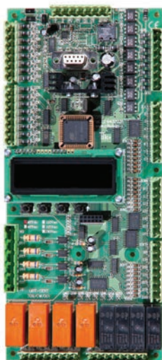
Fot. 2. Polski sterownik dźwigowy produkowany przez firmę Cito; jego wielkość nie ogranicza funkcjonalności – sterować może windami do 24 przystanków
